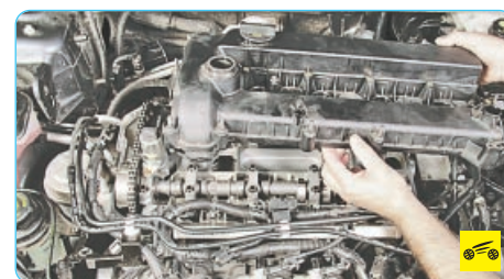
2. Выверните все свечи зажигания.
