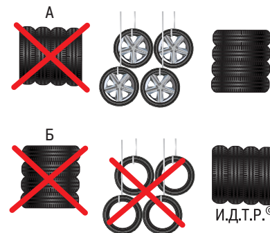
Рис. 14.6. Способы хранения шин: А – хранение колес в сборе с шинами; Б – хранение шин
