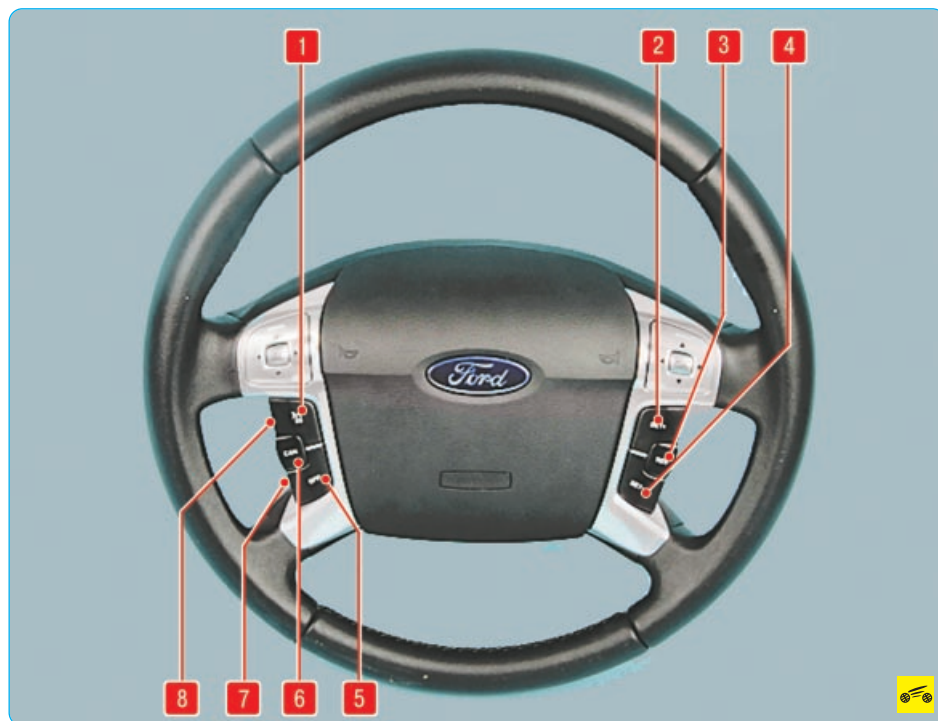
Рис. 1.13. Клавиши управления круиз-контролем: 1 – клавиша «ON» (включения круиз-контроля); 2 – клавиша «SET+» повышения скорости; 3 – клавиша «RES» (восстановления работы круиз-контроля); 4 – клавиша «SET-» снижения скорости; 5 – клавиша «OFF» выключения круиз-контроля; 6 – клавиша «CAN» временного выключения круиз-контроля; 7 – клавиша уменьшения дистанции (автомобиль с адаптивным круиз-контролем); 8 – клавиша увеличения дистанции (автомобиль с адаптивным круиз-контролем)
