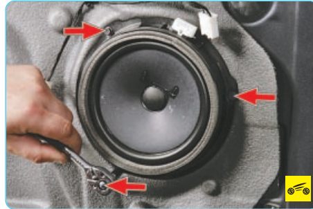
5. Выверните три болта крепления динамика к панели двери...
