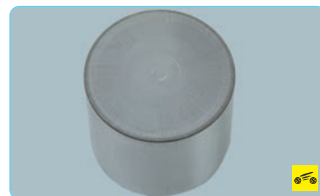
Зазоры регулируют подбором толщины толкателей. В запасные части поставляют наборы толкателей разной толщины.
