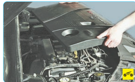
2. Снимите декоративный кожух двигателя (см. «Снятие и установка декоративного кожуха двигателя», с. 73).
