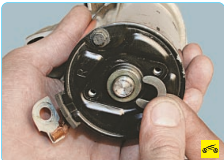
9. Снимите стопорное кольцо...
