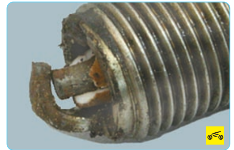
8. Механические повреждения электродов и изолятора свечи.
