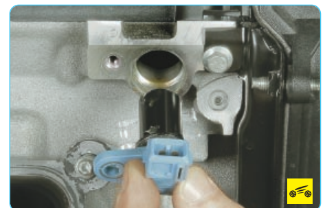
5. ...и извлеките датчик из отверстия в головке блока цилиндров.
