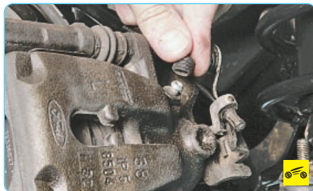
6. Снимите защитный колпачок клапана.
