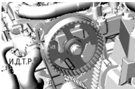
Рис. 5.52. Фиксация шкива выпускного распределительного вала
