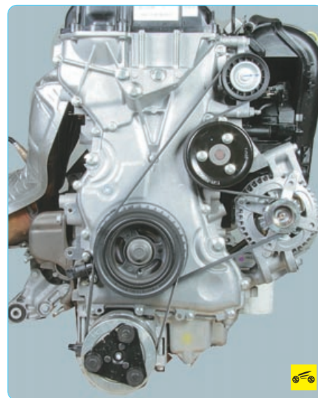
Так расположен на двигателе ремень привода вспомогательных агрегатов.
