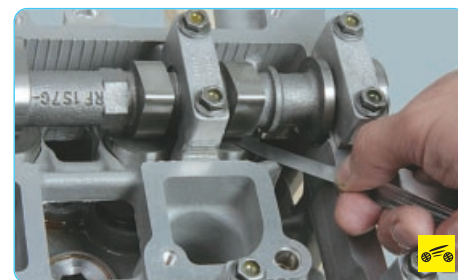
Зазор измеряют щупом на холодном двигателе (при температуре +20 °С) между кулачком распределительного вала (кулачок должен быть направлен вверх от толкателя) и толкателем клапана. Номинальный зазор для впускного клапана составляет 0,17–0,23 мм, для выпускного – 0,31–0,37 мм.
