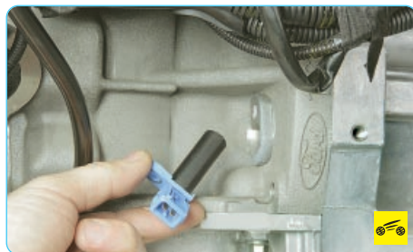
5. ...и извлеките датчик из отверстия в блоке цилиндров.
