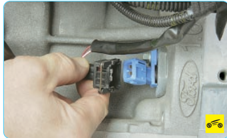
3. ...и отсоедините колодку жгута проводов от выводов датчика положения коленчатого вала.
