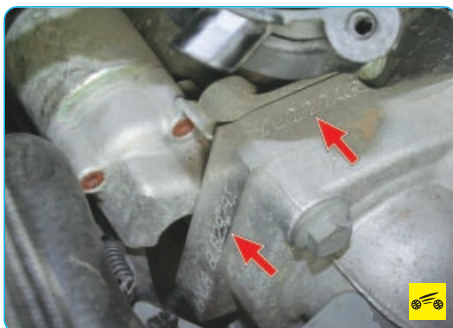
Рис. 1.9. Расположение номера и обозначения модели бензиновых двигателей рабочим объемом 1,6 л (дрессельный узел для наглядности снят)
