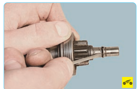
20. ...и снимите стопорное кольцо, поддев его отверткой.
