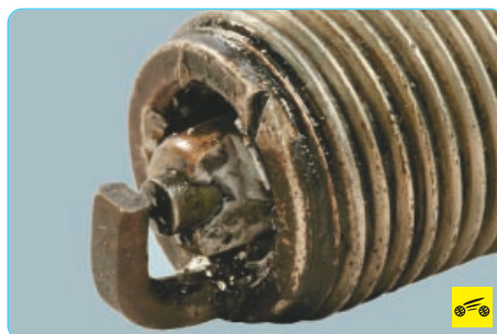
7. Изолятор свечи растрескавшийся или со сколами.
