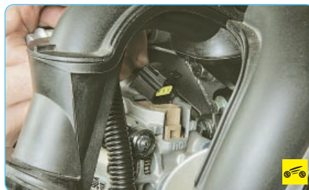
7. Нажмите на фиксатор и отсоедините подложку жгута проводов от выводов генератора.
