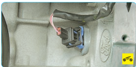
5. ...и извлеките датчик из отверстия в блоке цилиндров.
