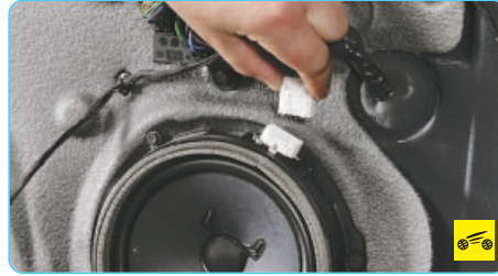
4. ...отсоедините колодку жгута проводов от динамика акустической системы.
