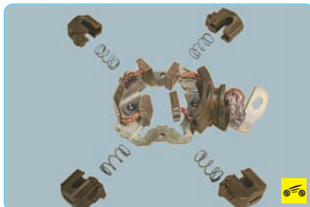
14. При необходимости снимите корпуса щеток и пружины.
