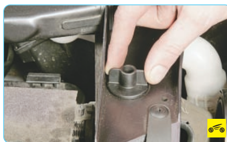
7. Выверните верхние крепления радиатора...
