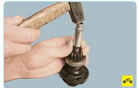
19. Сдвиньте по валу планетарного редуктора ограничительное кольцо...
