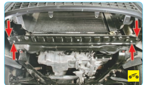
Так расположены болты крепления поперечины.
