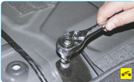
11. Выверните винт опорного кронштейна левой спинки заднего сиденья.
