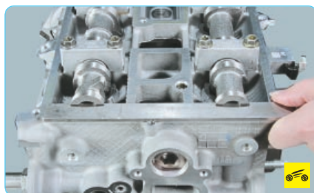
14. Установите фиксирующую пластину в специальные пазы в задней части распределительных валов.
