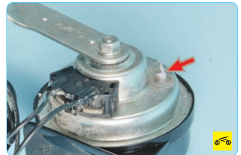
6. ...и снимите звуковые сигналы.
