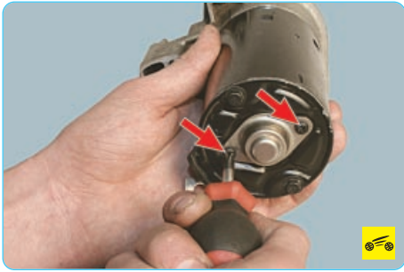
6. Выверните два винта крепления крышки подшипника...
