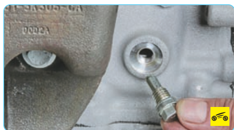
10. ...и извлеките заглушку, расположенную в передней части блока цилиндров справа.
