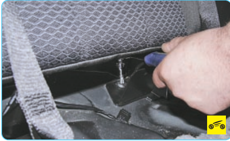
8. Выверните винт крепления левого...
