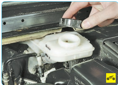
2. ...и снимите пробку бачка главного тормозного цилиндра.
