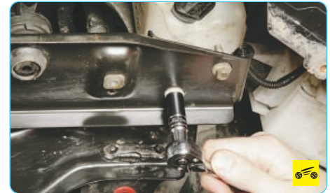
9. Выверните по два болта крепления поперечины передка и снимите поперечину в сборе с радиатором и электровентилятором. При необходимости снимите радиатор с поперечины.
