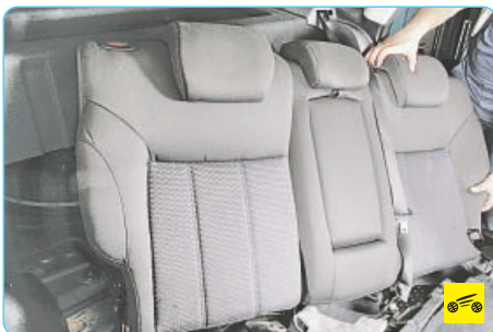
12. Извлеките спинки заднего сиденья из салона автомобиля.
