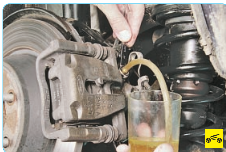
9. Отверните на 1/2–3/4 оборота клапан для выпуска воздуха. Из шланга начнет вытекать старая (грязная) тормозная жидкость. Педаль тормоза должна в это время плавно прийти до упора вниз. Как только жидкость перестанет вытекать, заверните клапан выпуска воздуха.
