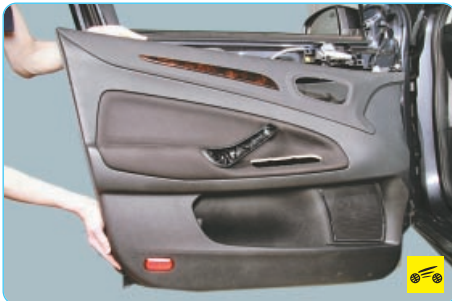
7. Установите динамик акустической системы и все снятые детали в порядке, обратном снятию.
