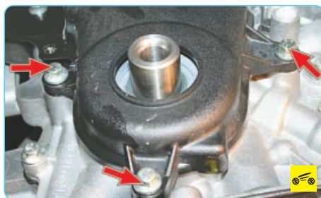
Рис. 5.19. Заглушка отверстия для установки фиксирующего стержня коленчатого вала
