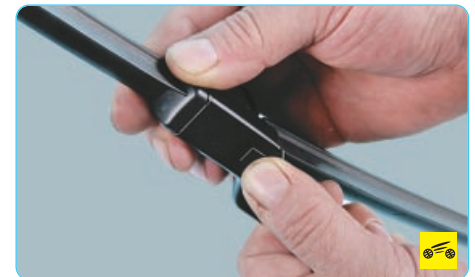
2. Нажмите на фиксатор адаптера щетки...
