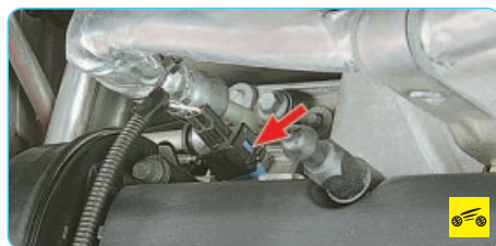
Датчик положения распределительного вала установлен сверху на головке блока ци-
