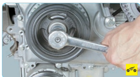
12. Осторожно проверните коленчатый вал за болт крепления его шкива до момента установки вала фиксирующим стержнем.
