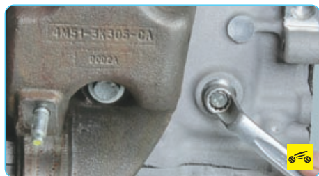
11. Вверните фиксирующий стержень (приспособление M10x1,5).
