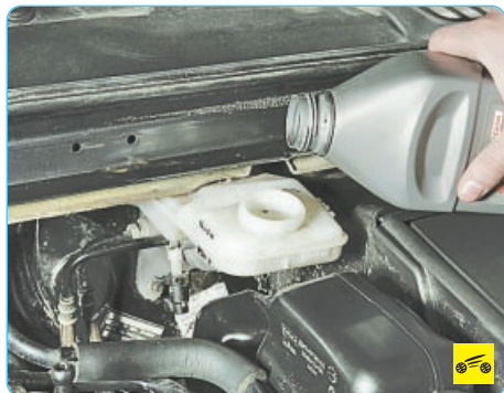
4. Долейте новую тормозную жидкость до нижней кромки наливной горловины.
