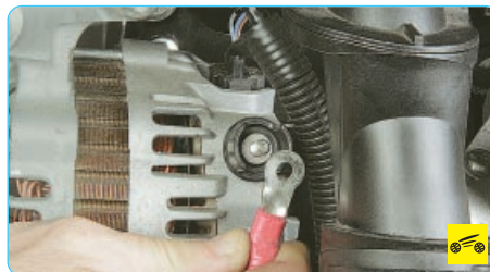
6. ...и снимите клемму с вывода «плюс» генератора.
