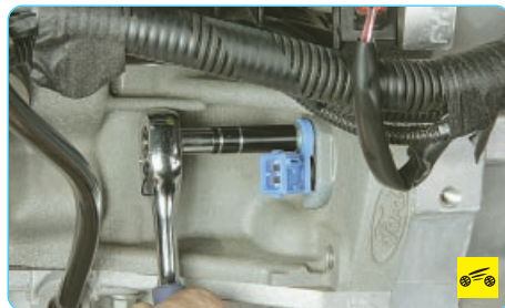
4. Выверните болт крепления датчика...
