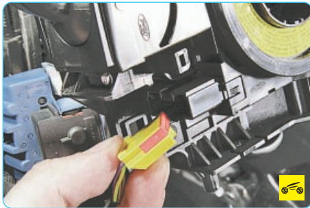
7. ...отсоедините колодку жгута проводов от контактного кольца подушки безопасности водителя.
