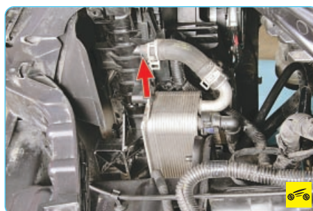
6. Аналогично отсоедините от патрубка радиатора верхний подводящий шланг.
