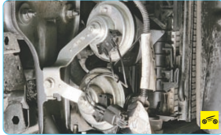
6. ...и снимите звуковые сигналы.
