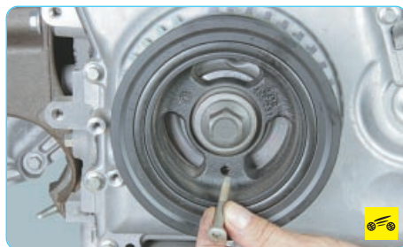
13. На двигателях Duratec-HE объемом 2,0 и 2,3 л вверните болт M6x18 через отверстие в шкиве коленчатого вала в резьбовое отверстие крышки привода газораспределительного механизма, зафиксировав тем самым коленчатый вал от проворачивания.
